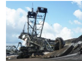
Schaufelradbagger im Rheinischen Braunkohlenrevier Foto: Lieven
